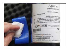
Retirar la membrana hipobárica del liner y limpiar con acetona el lado del que va a ser pegada.
