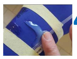
Aplicar el pegamento sobre el tejido del liner entre las cintas adhesivas de protección. Asegurarse de que las costuras están cubiertas pues de otro modo no se podrá generar el vacío necesario.
